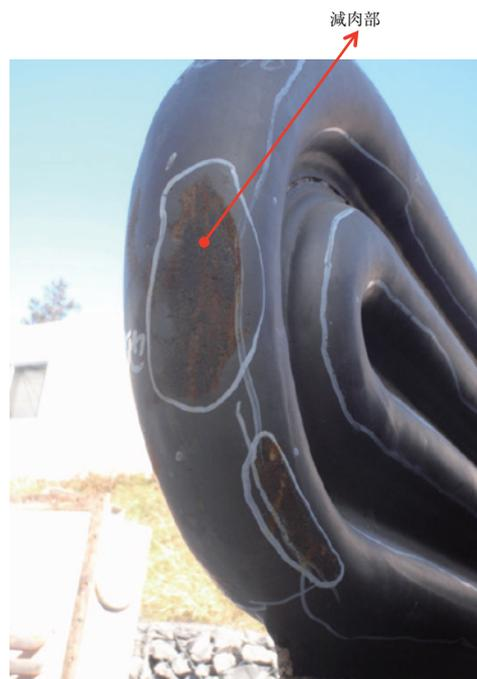
図4-18 実機層内伝熱管外観写真
