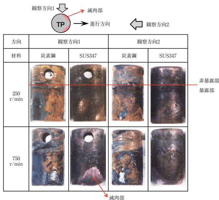
図4-20 実験後の試験片外観写真
