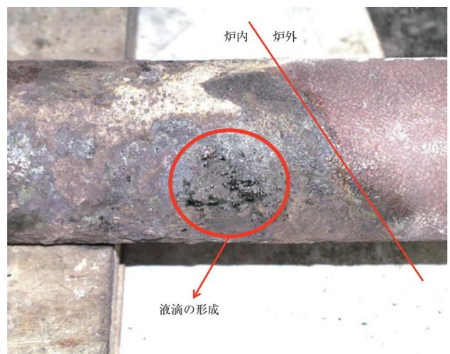
図4-3 暴露試験後の伝熱管外観写真
