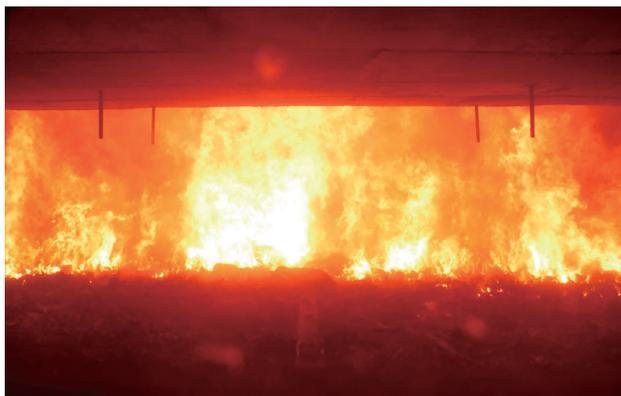
図5 4ラン型ストーカ式焼却炉内の燃焼状況
