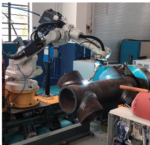
図8 管寄せと同径ノズルの鞍型溶接
