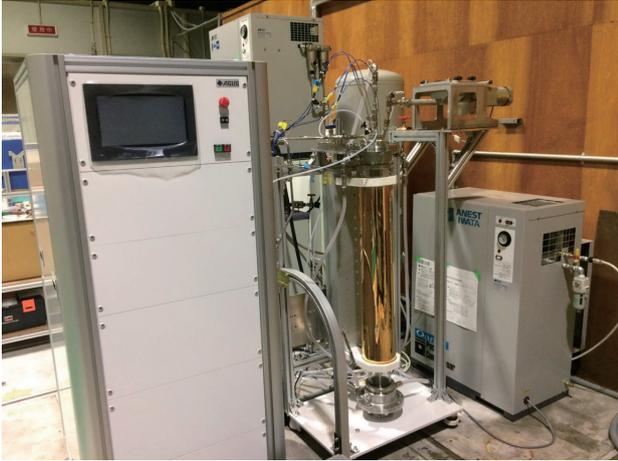
図4 流動層試験装置
