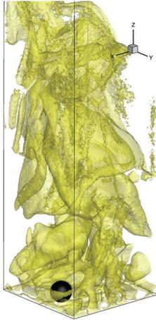
図9 流動層中の粗大球挙動の数値解析例<sup>9)</sup>
