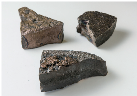
溶融メタル。溶融した焼却灰から金、銀、プラチナ、銅などの金属が採れる
