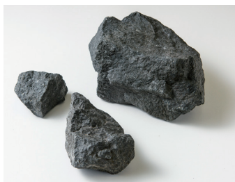
溶融還元石。溶融した焼却灰の約半分は溶融還元石になる。建築資材などに使われる
